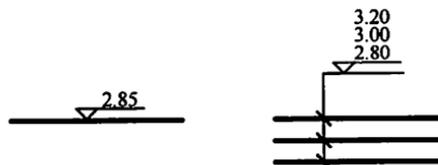
图 2.3.5-1 平面图中管道标高标注法
