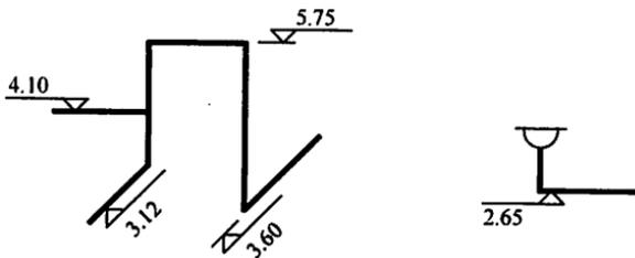
图 2.3.5-4 轴测图中管道标高标注法
