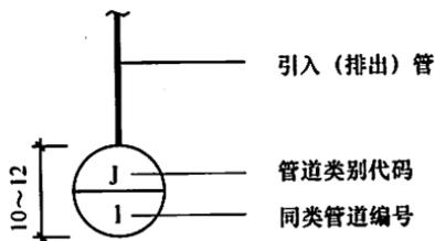
图 2.5.1 给水引入(排水排出)管编号表示法
