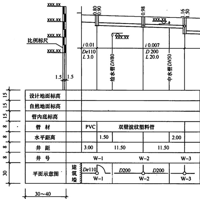
图 4.4.4-2 污水(雨水)管道纵断面图(纵向 1:500, 竖向 1:50)
