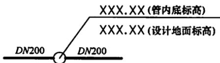
图 4.4.3-1 检查井上、下游管道管径
