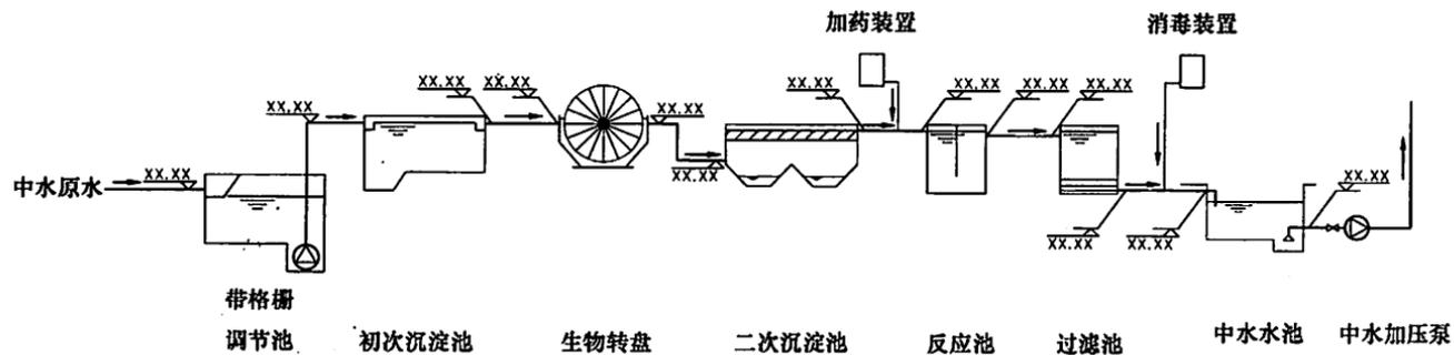
图 4.8.2 水净化处理工艺流程断面图画法示例
