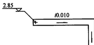
图 2.3.5-2 平面图中沟渠标高标注法
