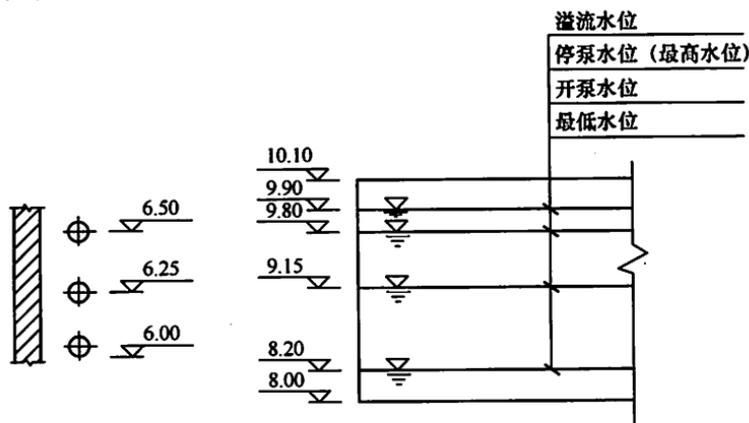
图 2.3.5-3 剖面图中管道及水位标高标注法
